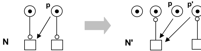
Rys. 33. W sieci N' pustość (inhibitorowego) warunku p jest osiągalna, w sieci N – nie
